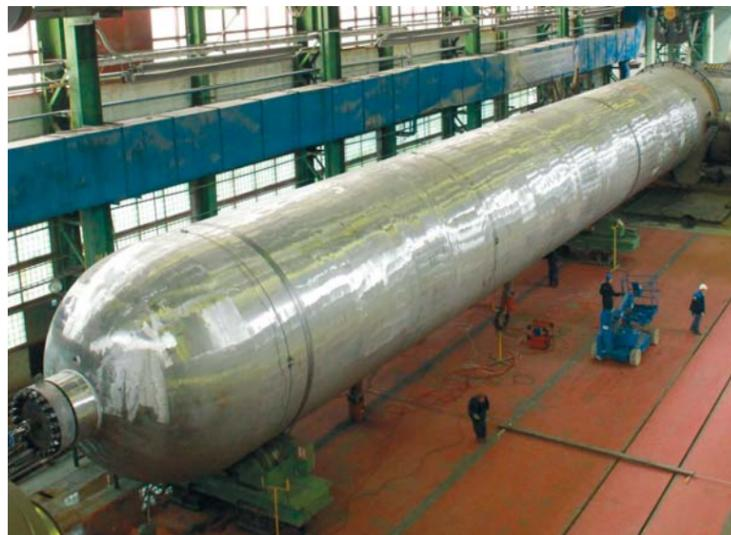
Реактор-рекордсмен после гидроиспытаний
