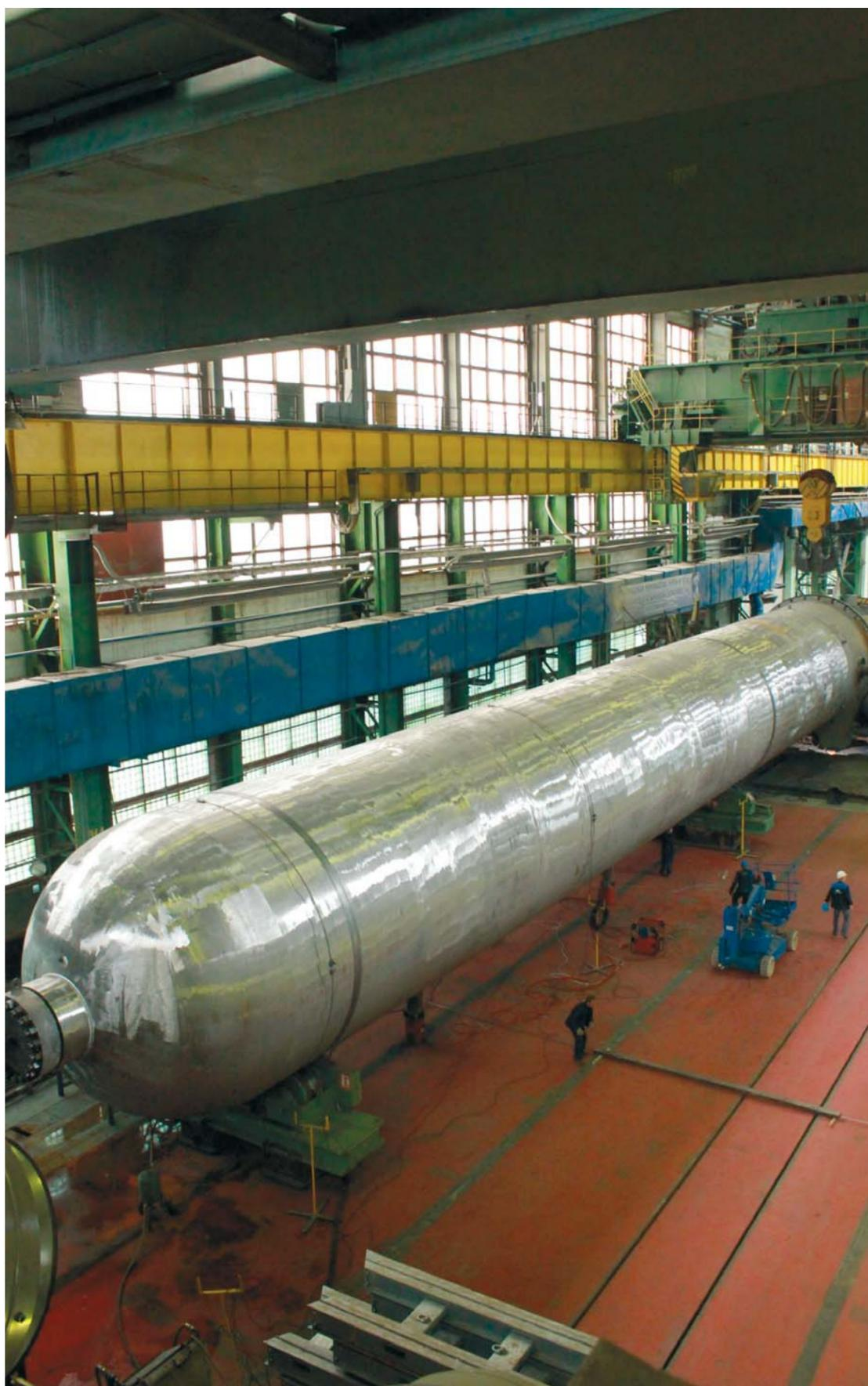
На Ижорских заводах успешно прошли гидроиспытания третьего реактора, изготовленного по заказу ООО «РН-Туапсинский НПЗ». Уникальный сосуд массой более 1300 тонн готовится к отгрузке в адрес заказчика. Материалы о том, как ижорцы работают над главным заказом текущего года
